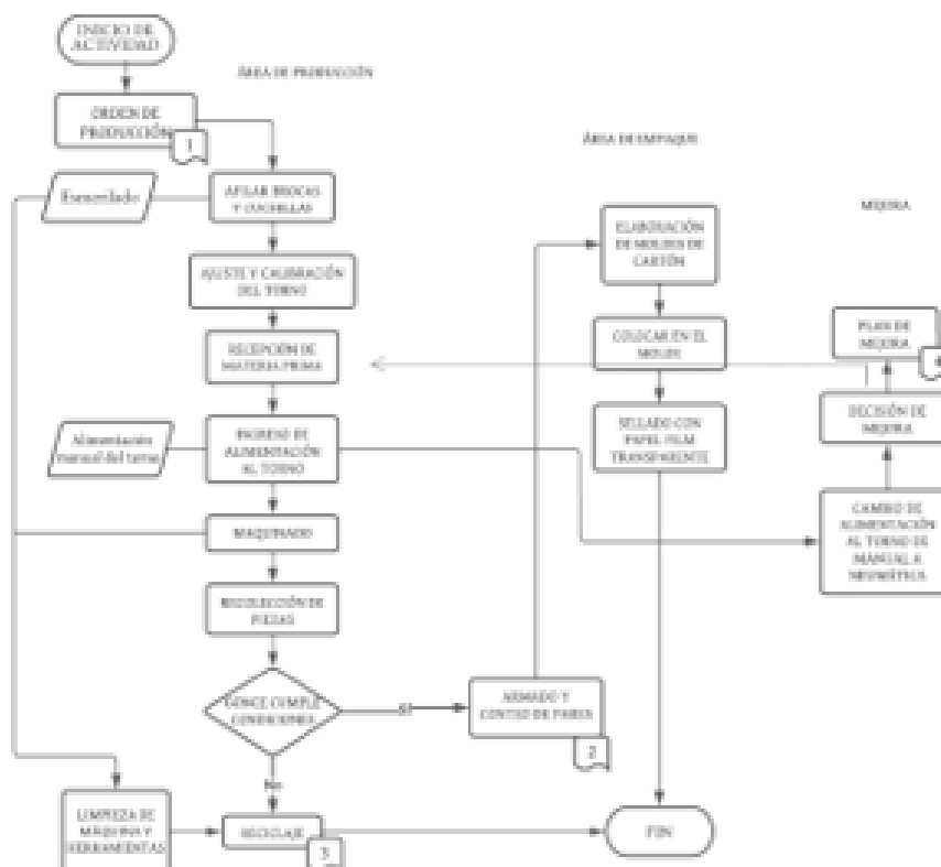
Diagrama de flujo del proceso de elaboración de gonces de metal.
