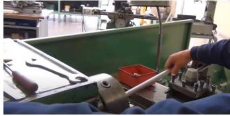
Figura 3.21: Alimentación de torno
