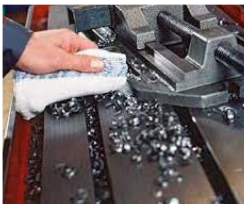
Figura 3.25: Limpieza de torno
