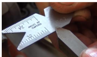
Figura 3.19: Afilado de cuchillas
