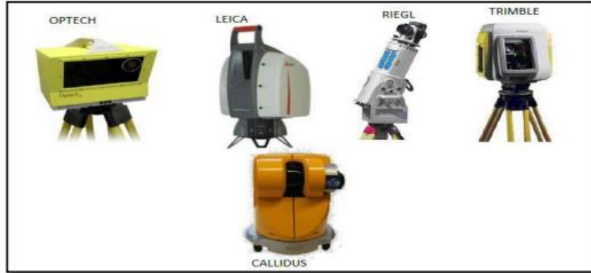
Figura 3.9: Ejemplos de scanner basados en tiempo de vuelo Fuente: [1]
