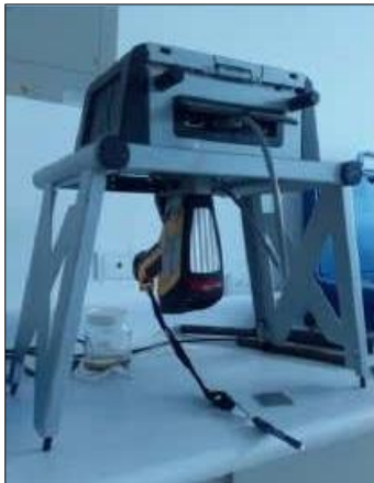
Figura. 3.22: Espectrómetro de fluorescencia de rayos x Fuente: [16]
