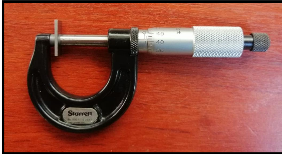
Figura 5.4: Medición del espesor de la paleta
