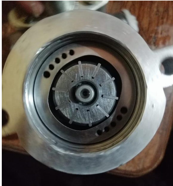
ANEXO IV: Componentes internos de la bomba de dirección hidráulica
