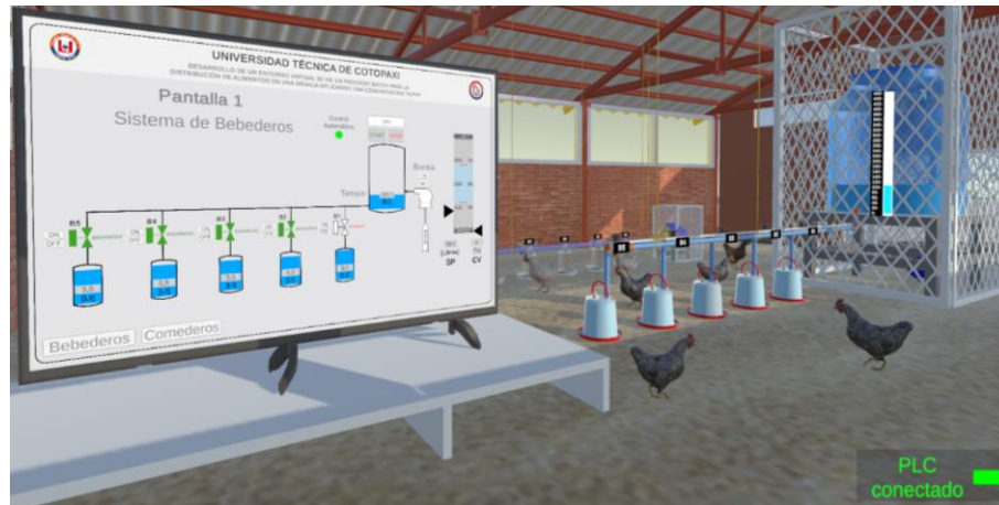
Figura 3.41 Llenado de los bebederos automáticamente con el PLC S7-1200
