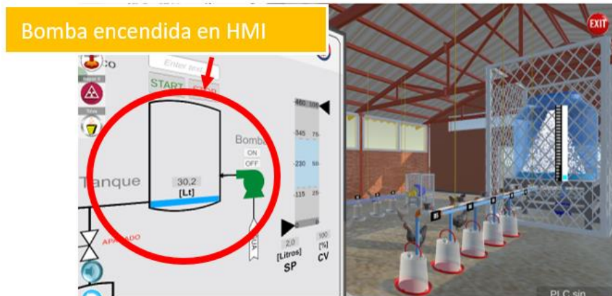
Figura 3.35 Encendido de la bomba de forma manual
