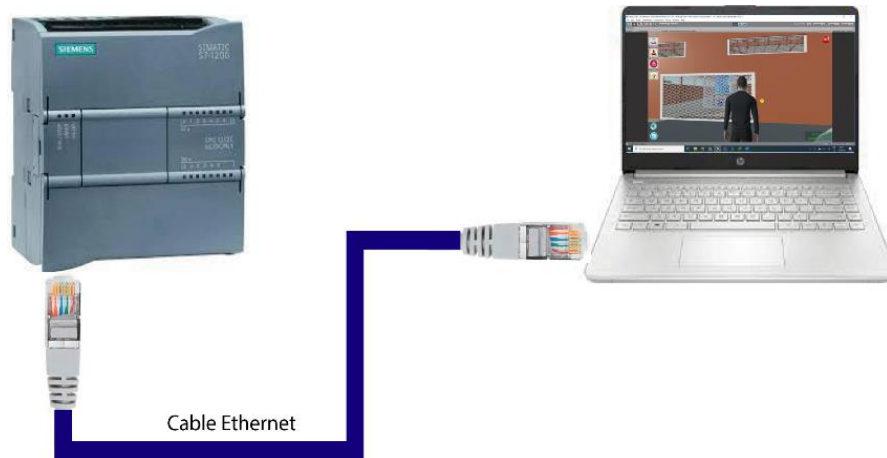
Figura 3.39 Conexión del PLC S7-1200 al computador con cable ethernet
