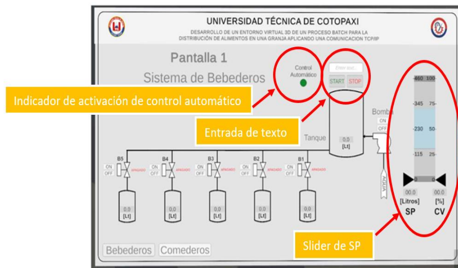
Figura 3.4 Pantalla 1 del HMI para control Automático del sistema de bebederos
