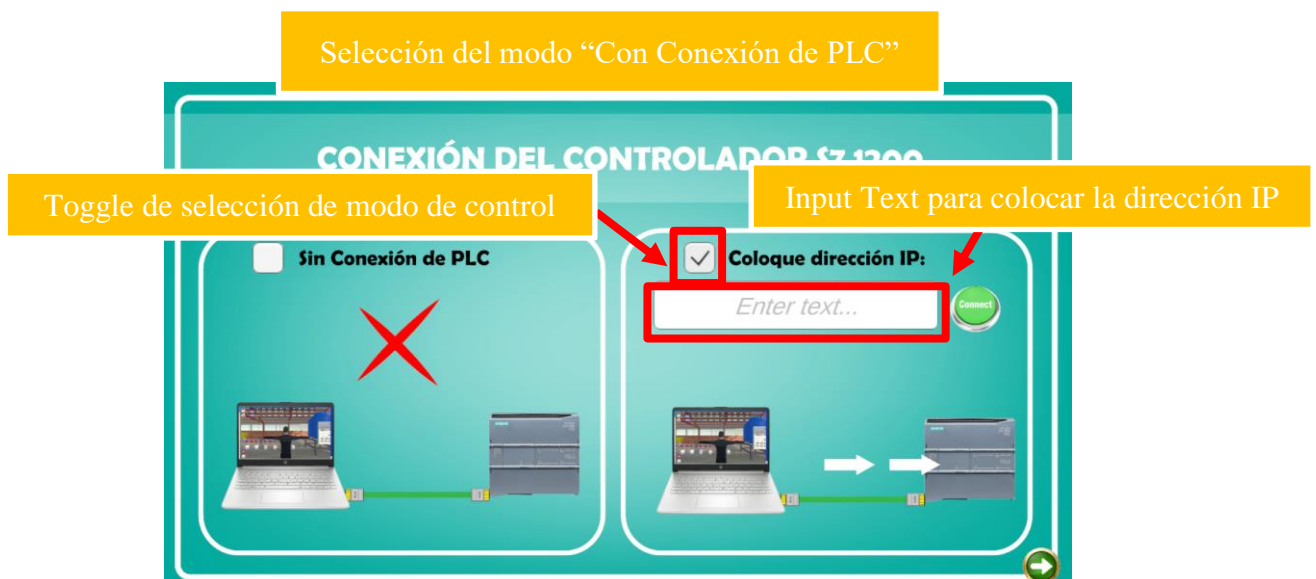
Figura 3.28 Ventana de conexión con el controlador PLC en modo "Con Conexión de PLC"
