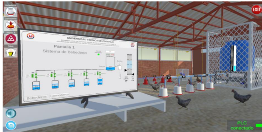
Figura 3.40 Llenado del Tanque automáticamente con el PLC S7-1200
