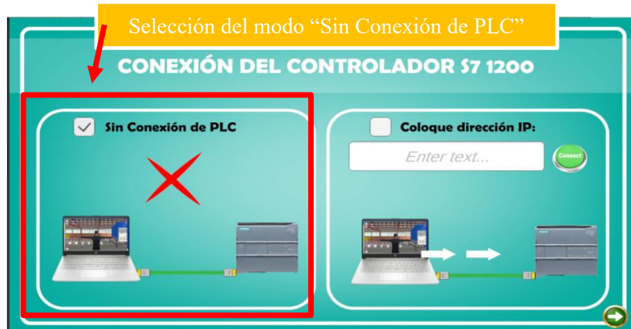
Figura 3.27 Ventana de conexión con el controlador PLC
