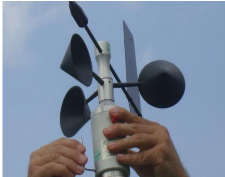
Figura 4.9. Monto el sensor en el mástil y aprieta el tornillo.
