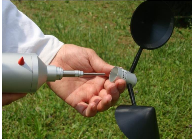
Figura 4.3. Se acoplo el rotor DNA124 en el cuerpo del sensor combinado
