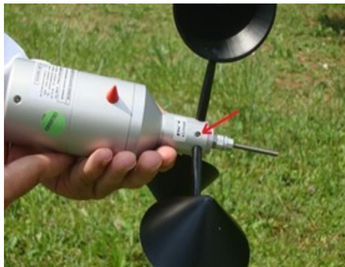
Figura 4.4. Apretar el tornillo del rotor que indica la fecha
