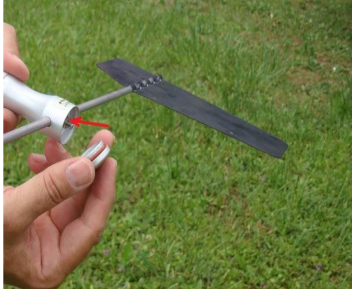
Figura 4.7. Aprieta la cubierta protectora.
