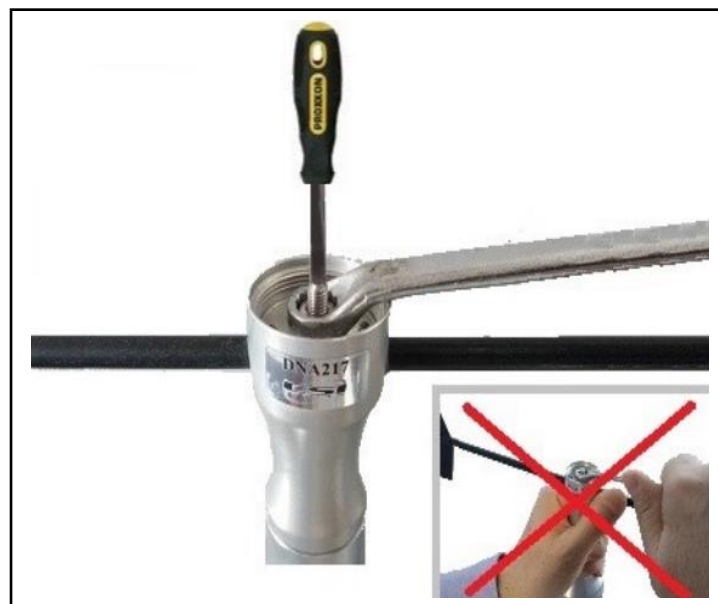
Figura 4.6. Insertó la arandela y la tuerca en el eje roscado
