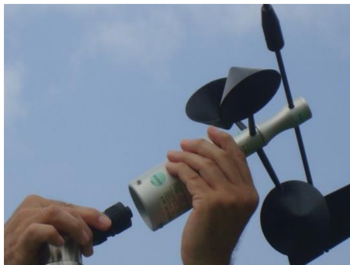
Figura 4.8. Conecto el cable al sensor.
