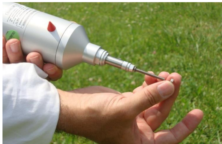
Figura 4.2. Desatornillar la tuerca de la arandela de la rosca del eje
