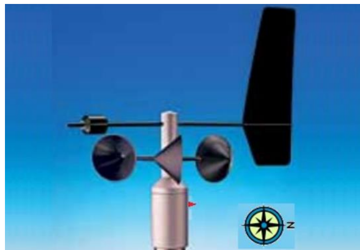
Figura 4.10. Cuando se aseguró el sensor en el poste, apuntamos la nariz roja hacia el NORTE para orientar
