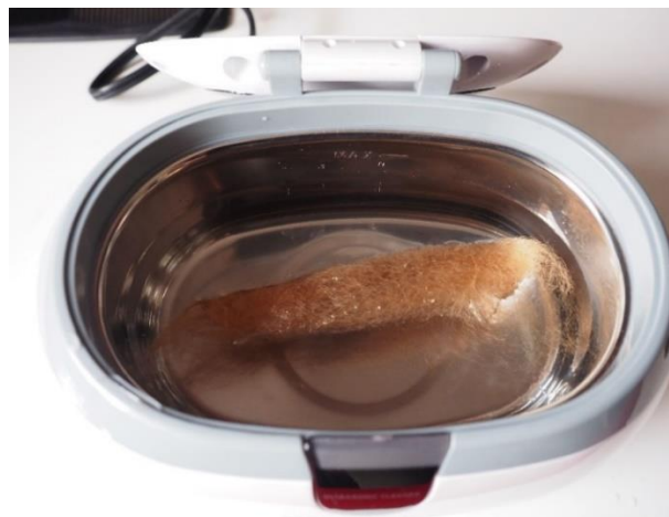
Fotografía 3. Lavado de fibra en equipo ultrasónico.
