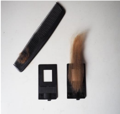
Fotografía 4. Peinado y colocación de muestra en la porta muestra.
