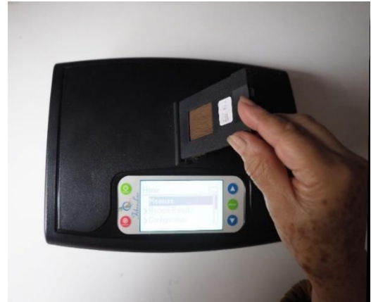
Fotografía 5. Colocación de muestra en el Fibrelux para determinar diámetro.
