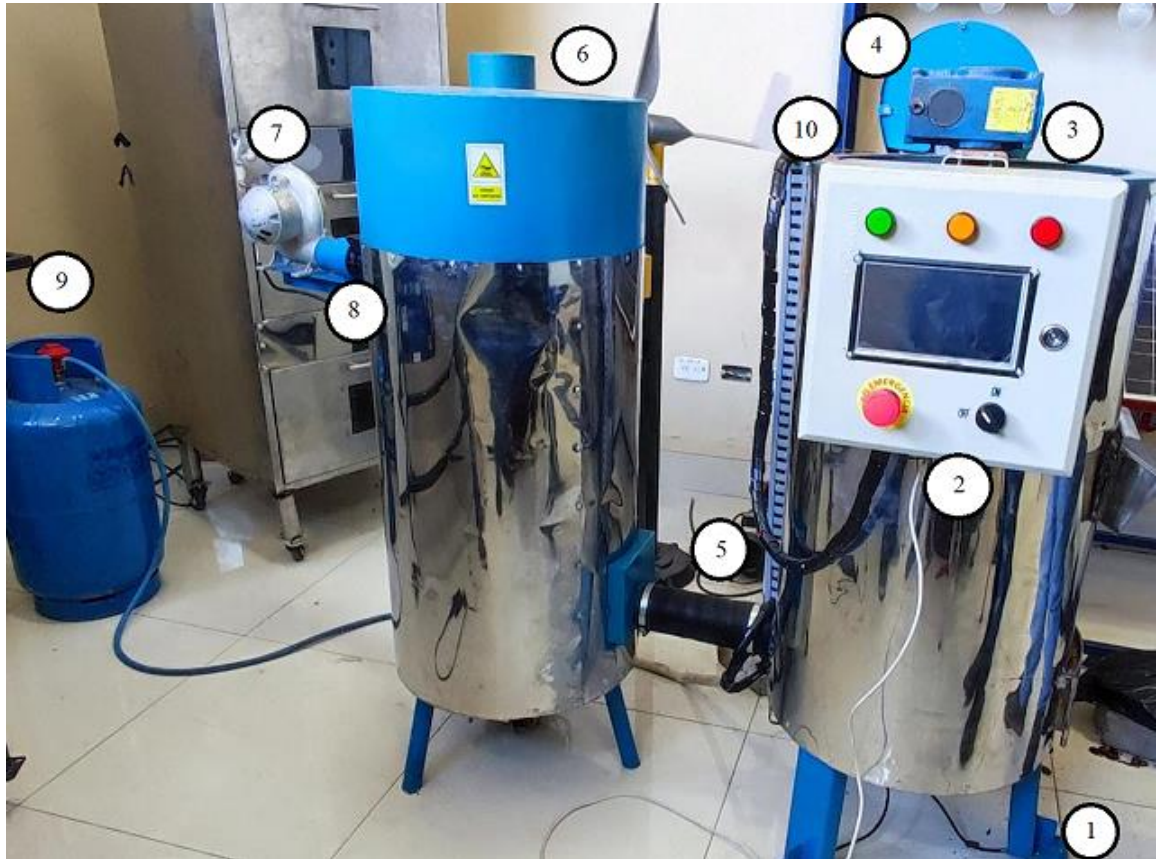
Figura 3.21: Componentes del secador cilíndrico
