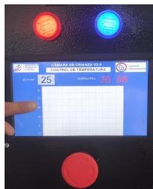
6. Si desea obtener los datos de temperatura, destapar la parte frontal del interfaz de control, ubique el módulo lector de memoria y retire la tarjeta de memoria.
