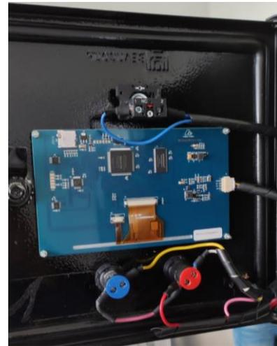
Figura N°- 22 Conexión del paro de emergencia
