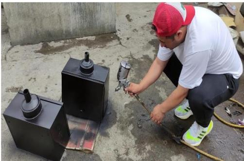
Figura N°- 5 Pintado de los sistemas de calefacción
