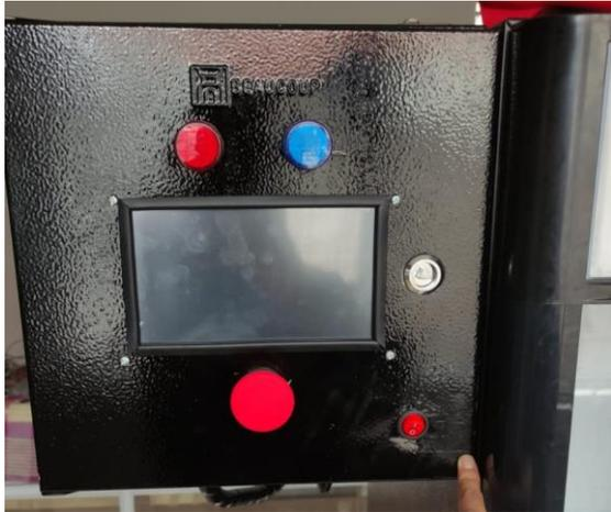
Figura N°- 21 Instalación paro de emergencia
