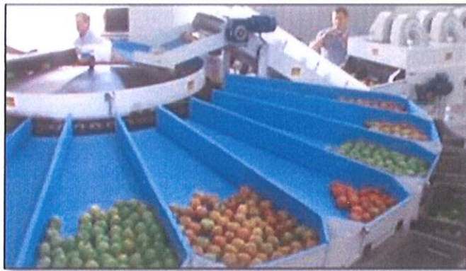
Figura 3.14: Máquina clasificadora de frutos mediante tambor giratorio [1].
