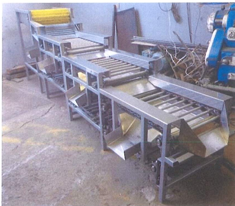
Figura 3.2: Máquina clasificadora de tomate riñón- variedad Daniela [2].
