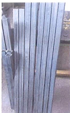
Figura 5.1 Tubos cortados para la construcción de la estructura.
