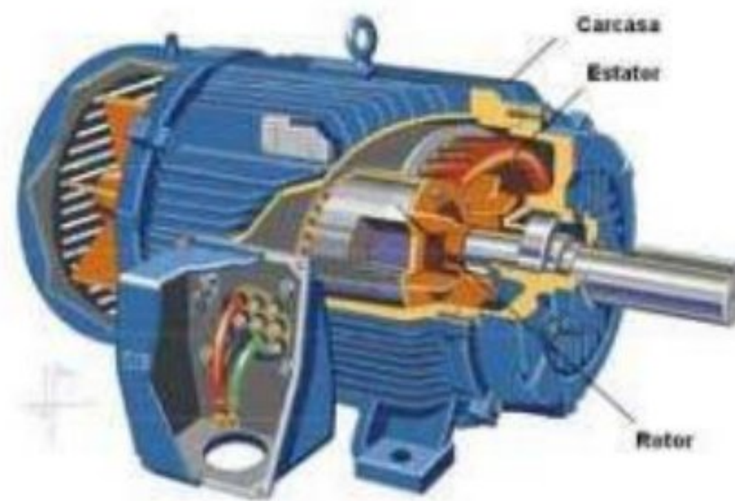
Figura 3.10. Partes de un motor eléctrico [11]
