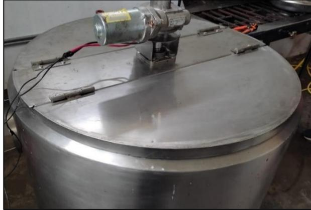
**Figura 4.28.** Montaje de la tapa en la marmita
