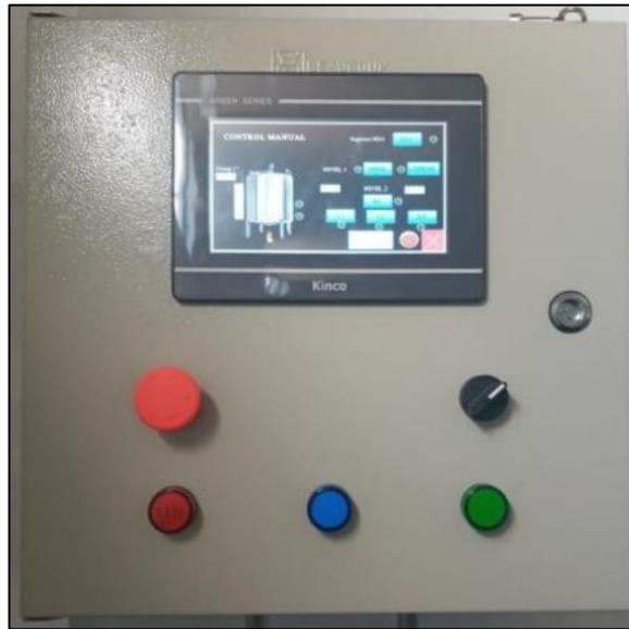
**Figura4.17.** Tablero gráfico del control
