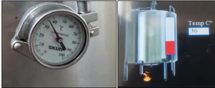
**Figura 5.3.** Comparación y calibración del sensor automático
