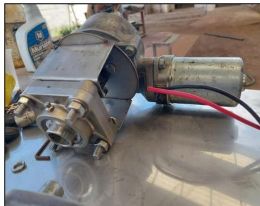
**Figura 4.25.** Acoples y chumaceras en el motor DC.
