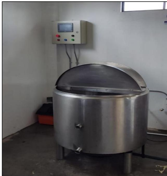
**Figura 4.29.** Instalación finalizada del proceso de pasteurización
