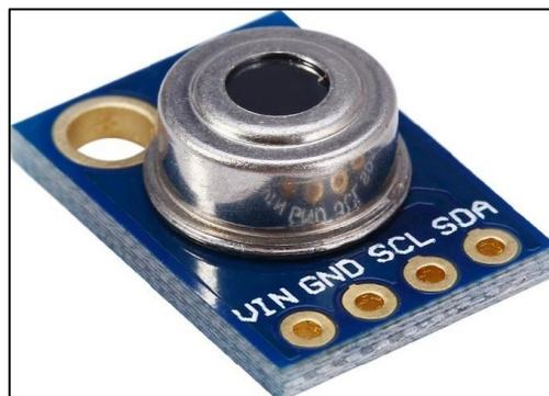
**Figura 4.3.** Sensor de temperatura MLX90614 [51]
