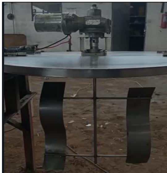
**Figura 4.27.** Ensamble del proceso de mezclado para la marmita
