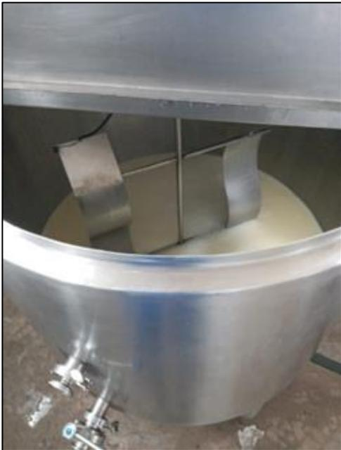
Mezcla de la materia prima a través de un motor y paleta diseñada
