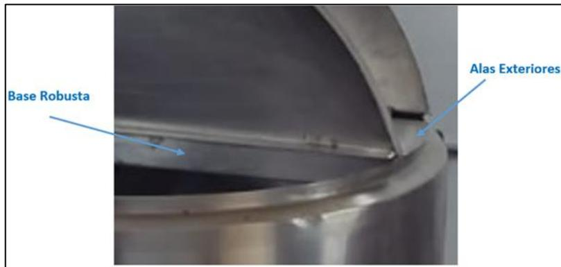
**Figura 5.2.** Detalles de los acoples mecánicos
