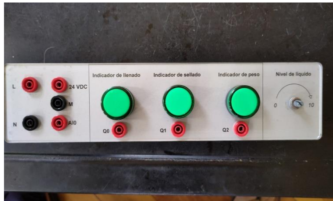
Figura 3.55 Nivel de líquido (potenciómetro)
