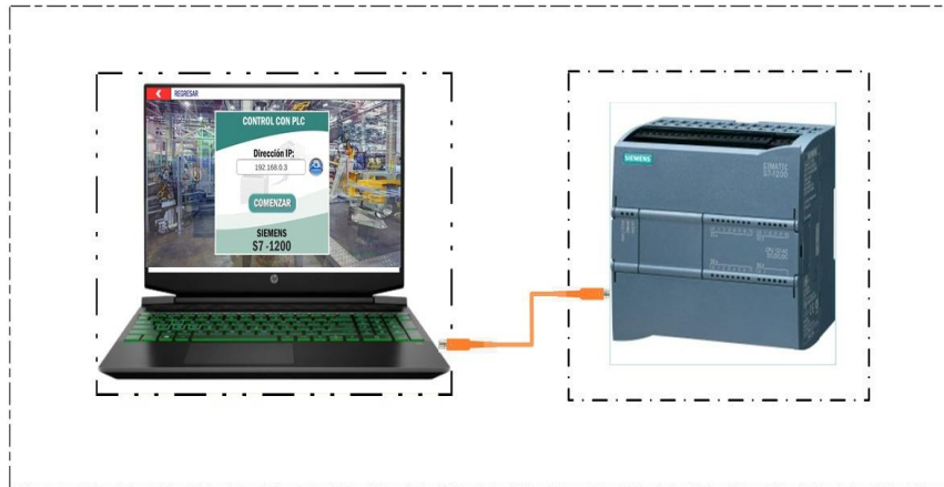
Figura 3.41 Conexión entre el ordenador y el PLC.
