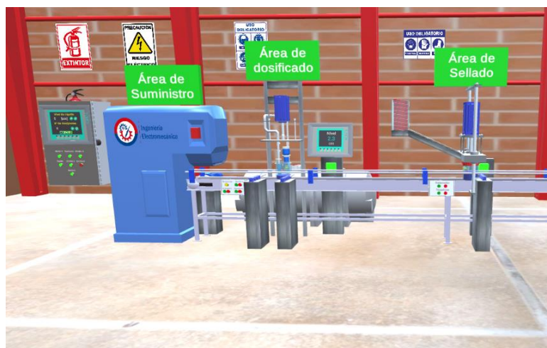
Figura 3.37 Parte 2 del proceso (área de suministro, dosificado y sellado)
