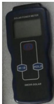
Fig. 3.9. Medidor de Energía Solar
