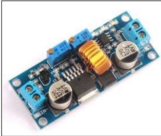
Figura 3.7. Fuente conmutada tipo “step-down”[24]
