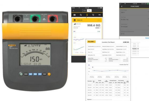
Figura 5.9. Medidores de aislamiento Fluke 1555 y 1550C.
