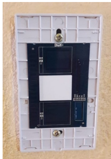
Figura 50. Ubicación de interruptores inteligentes en las cajas
