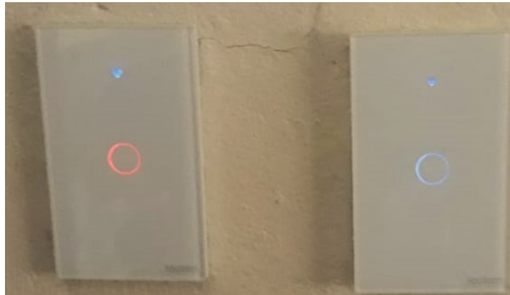
Figura 44. Interruptor inteligente de un canal (izquierdo apagado, derecho encendido)
