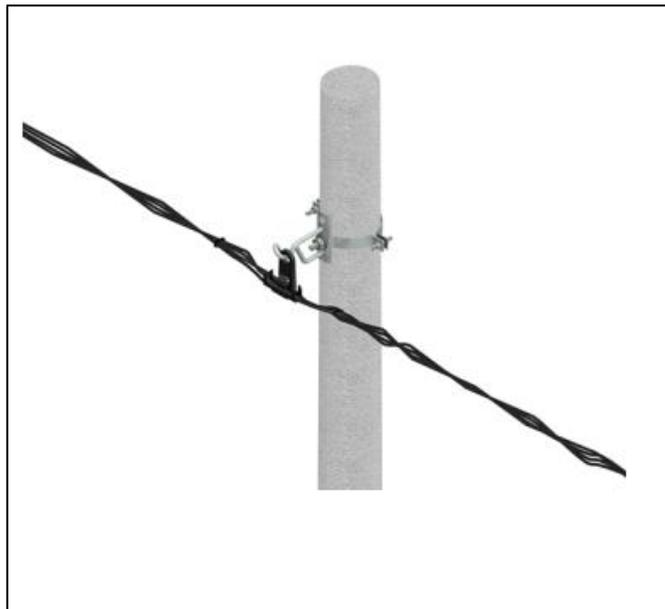
Fig. 1 Red secundaria (estructura pasante 1PP3) con cable preensamblado
