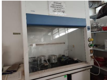
Cámara extractora de gases
