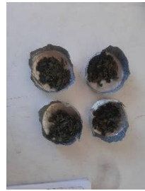
Medición de humedad
