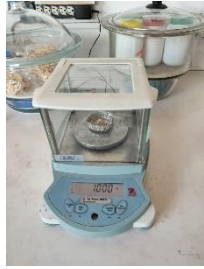
5 Medición para humedad
