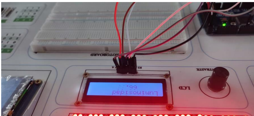
Foto 6: Comprobación de las lecturas del sensor LDR
