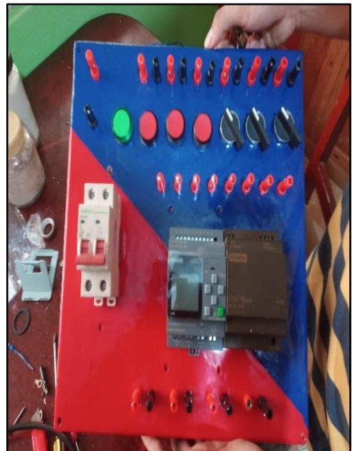
Figura 33: Conexiones del panel electro-neumático principal.
