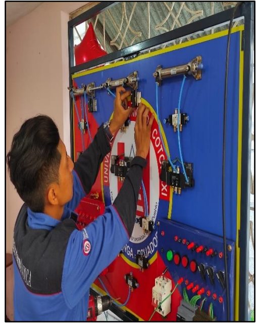
Figura 39: Instalación de los fines de carrera.
