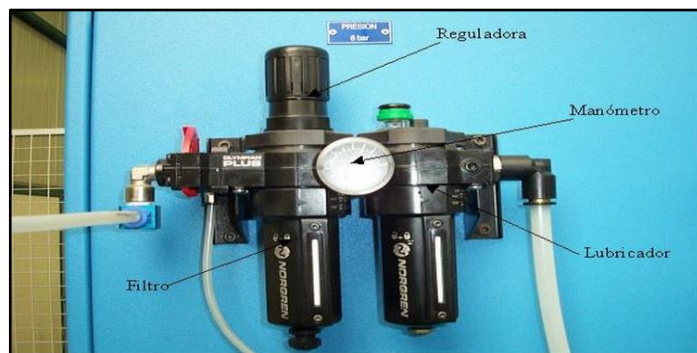
Imagen 3: Unidad de Mantenimiento.
