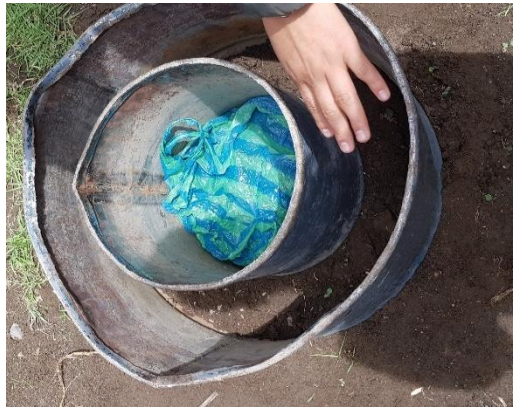
Fotografía No 6. Limpieza del lugar y ubicación de los anillos para la práctica del método de Doble Anillo para el Método de (MUNTZ).
