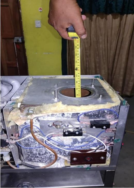
**Foto 2.** Selección de la resistencia de calor eléctrica y boya de nivel
