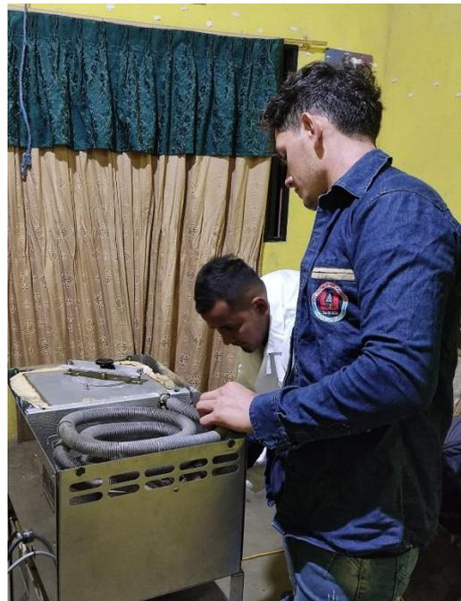
**Foto 9.** Montaje del cuerpo de destilación sobre el recipiente contenedor de agua destilada.
