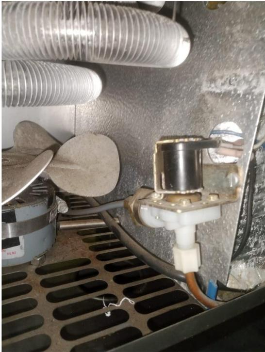
**Foto 6.** Instalación del ventilador que refrigera el serpentín.
