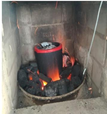
**Figura 3.** Colocación del metal a fundir.
