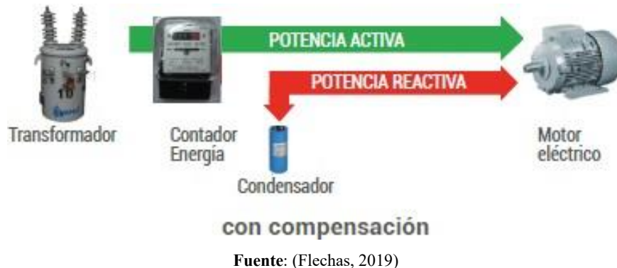
Figura 18. Corrección del factor de potencia en el punto de acometida principal o contador de energía
