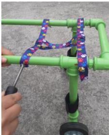
**Figura 12:** Asegurar el arnés con los tornillos auto perforantes.
