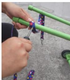
**Figura 14:** Ubicar el arnés y asegurarlo en la parte delantera.
