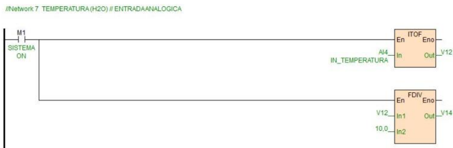
Figura 5.13: Programación de entrada analógica de temperatura
