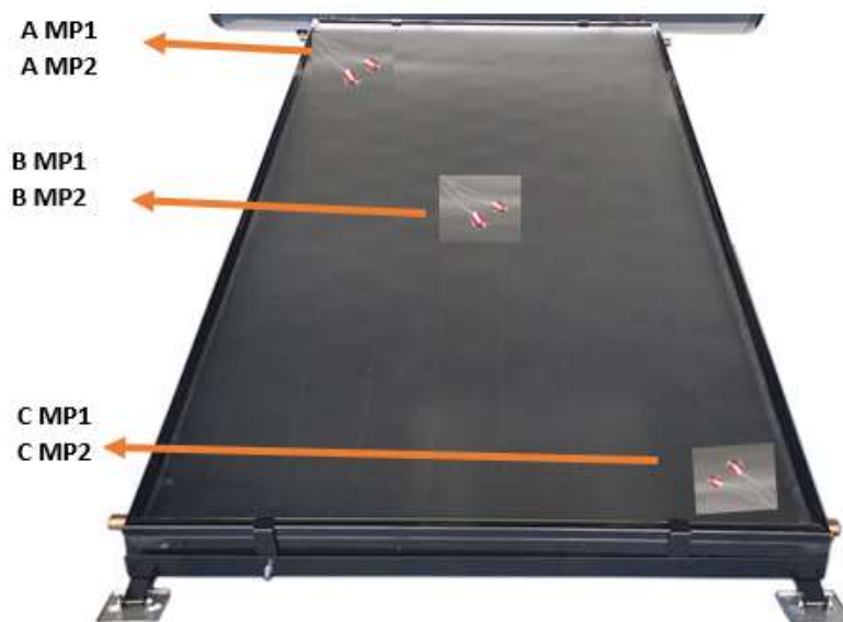
Figura 8. Ubicación de los sensores de temperatura en la placa absorbedora.
