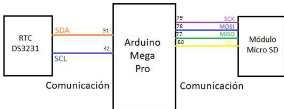
Figura 17. Esquema de conexión del módulo Micro SD y la RTC
