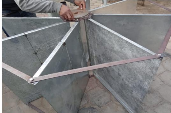
Figura 3. 20: Unión de los álabes a los tirantes de la rueda respectivamente.
