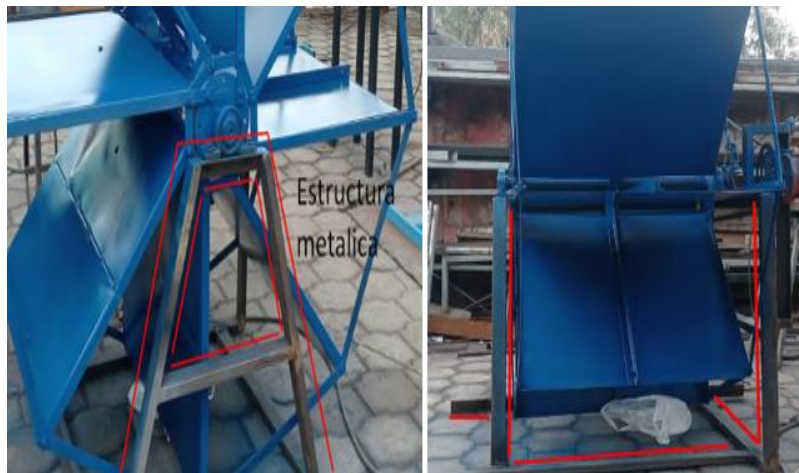
Figura 3. 29: Montaje de la Rueda Hidráulica.
