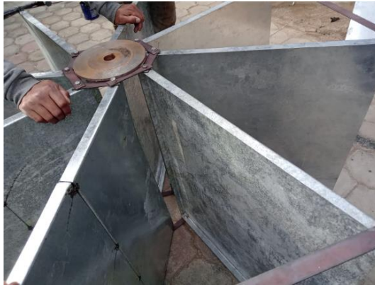
Figura 3. 18: Unión de los álabes con los apoyos.
