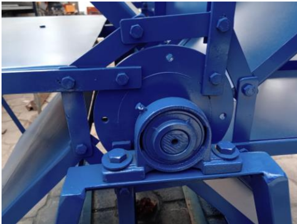
Anexo 7. 11: Ensamble de manzana y soportes
