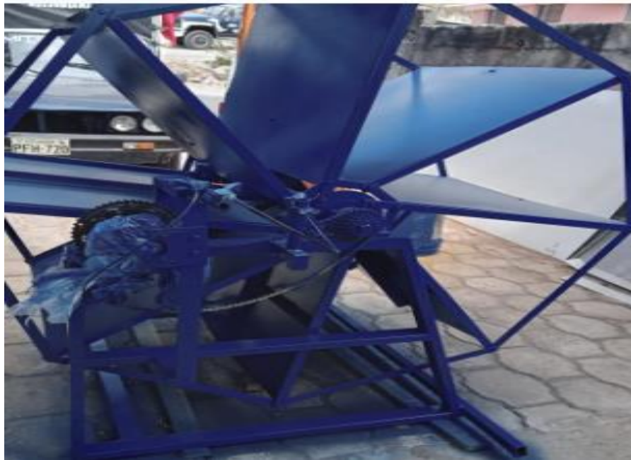
Anexo 7.16: proceso de pintura a la estructura y rueda hidráulica
