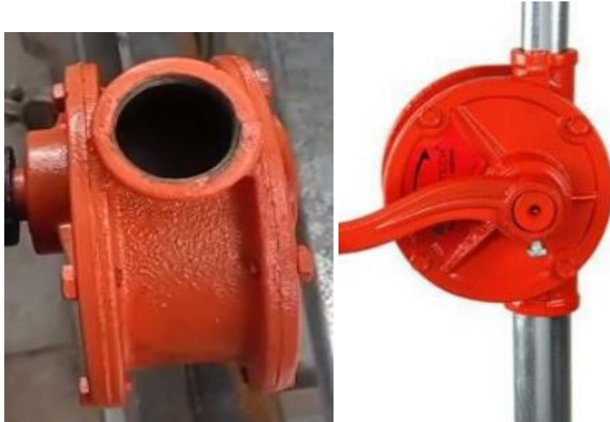
Anexo 7. 10: Bomba manual
