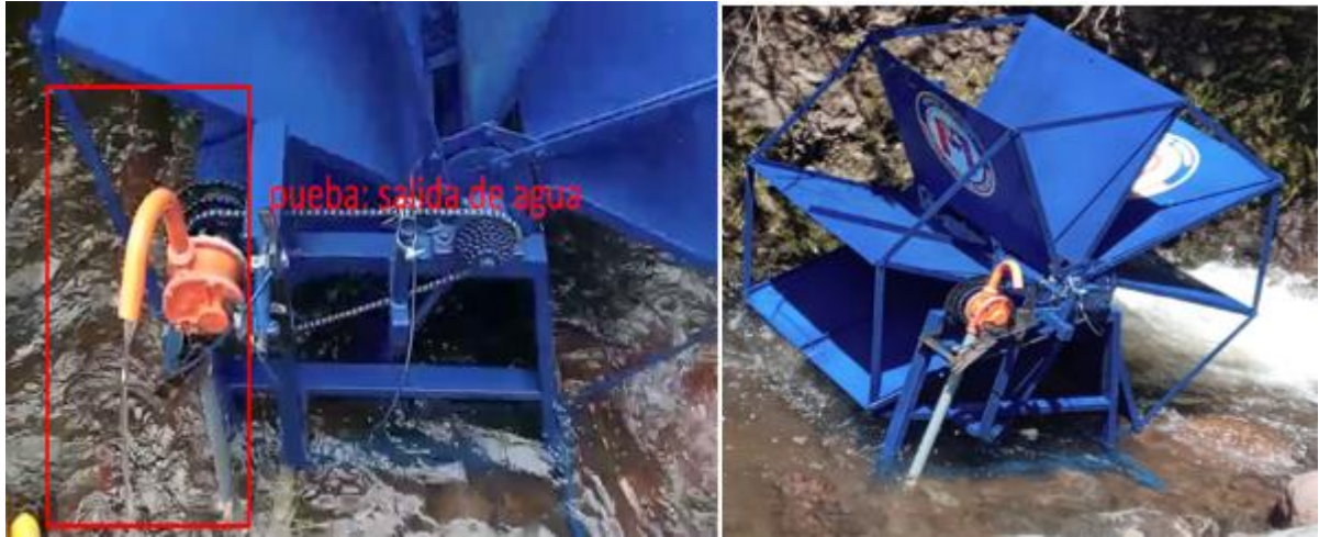
Anexo 7.23: Pruebas de salida de agua con instalación completa
