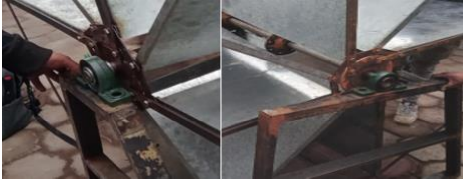
Figura 3. 22: Ubicación de chumaceras y piñón en el eje.
