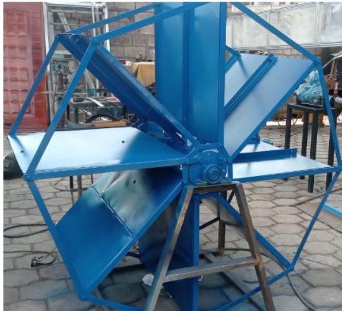
Anexo 7.15: Adaptación de rueda hidráulica en estructura (base)
