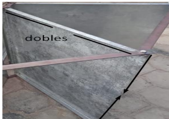
Figura 3. 17: Álabe de la rueda hidráulica.
