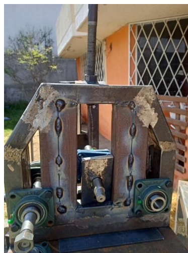
Figura 12. Soldadura del mecanismo de ajustar
