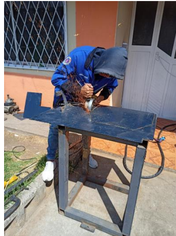
Figura 14. Corte de plancha para estructura triangular
