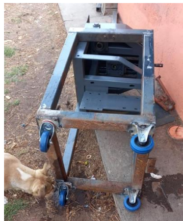
Figura 19. Soldadura de ruedas
