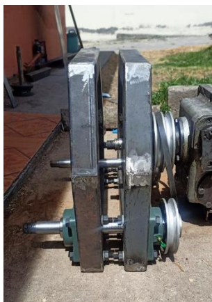
Figura 9. Comprobación de montaje motoreductor
