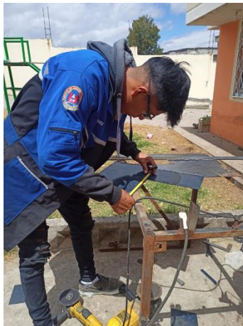
Figura 17. Medición de longitud a cortar
