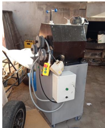
Figura 21. Máquina roladora de tubo terminada
