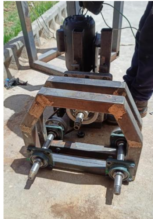
Figura 8. Perforación para el acople de chumaceras
