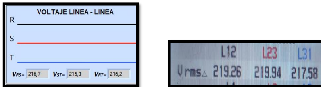
(a) Voltaje línea – línea medida por LabVIEW (b) Voltaje línea – línea medida por analizador de redes Figura 5.1: Calibración del voltaje
