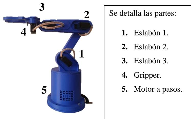
Figura 3.5. Armado total del robot antropomórfico
