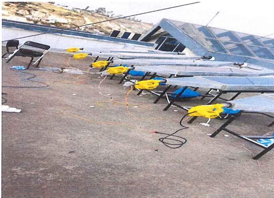
**Figura I.2:** Adquisición de datos de colectores solares con placas planas absorbedoras en igualdad de condiciones
