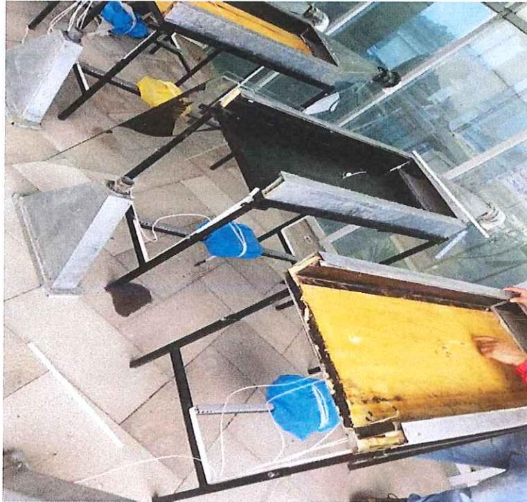
**Figura J. 1:** Cambio de placas absorbedoras en colectores solares
