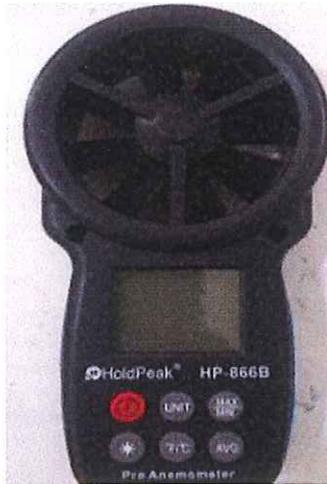
**Figura 3.10:** Anemómetro HoldPeak HP-866B
