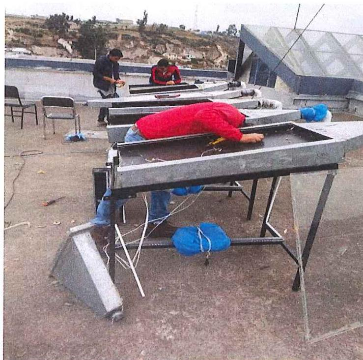
**Figura J. 2:** Armado de colectores solares
