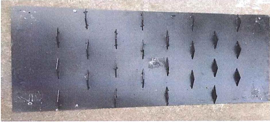
**Figura H.1:** Placa absorbadora con aletas triangulares
