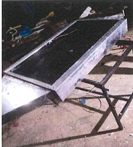
**Figura 3.6:** Carcasa del colector
