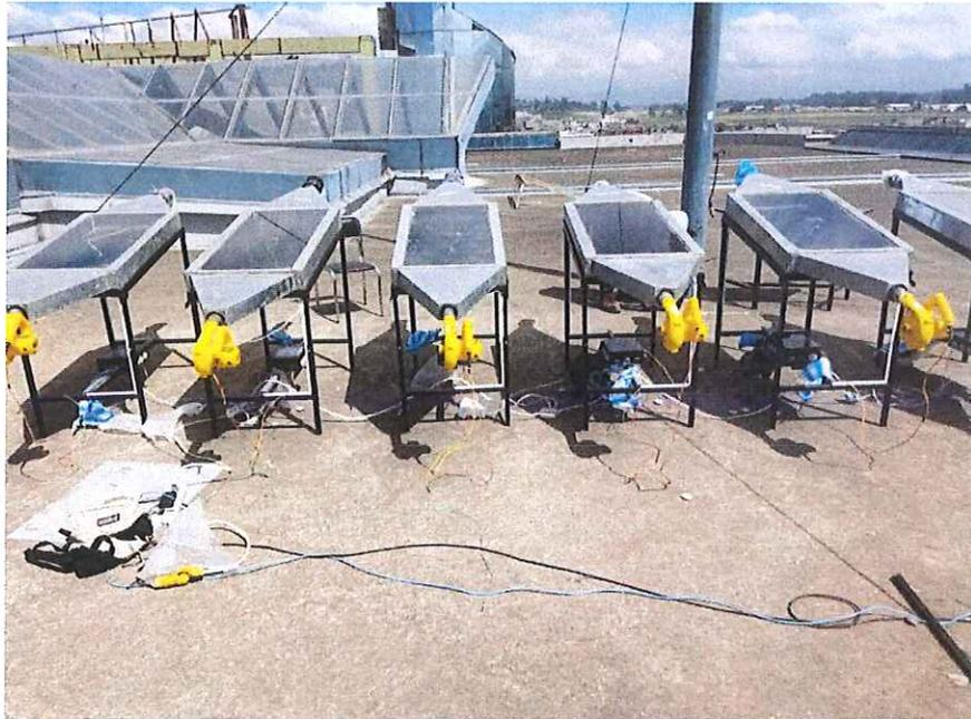
**Figura I.1:** Adquisición de datos de colectores solares con adición de aletas y variación de altura en igualdad de condiciones
