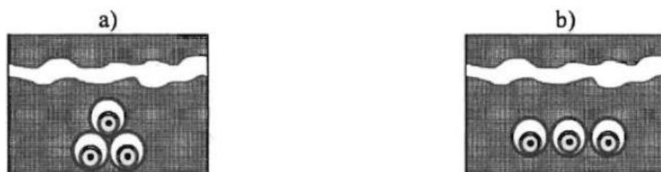
**Figura 3.16.** Cables colocados en ductos cerámicos [9].
