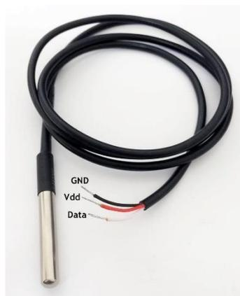
*Fig. 4.3 Sensor de temperatura DS18B20 [26].*
