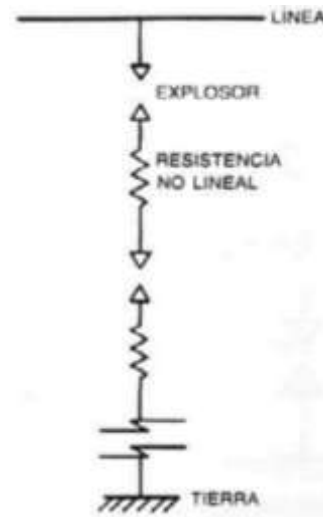
Figura 4. 18. Esquema del funcionamiento del descargador [11].
