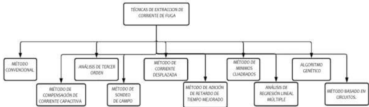
Figura 4. 3. Métodos para analizar la corriente de fuga [11].
