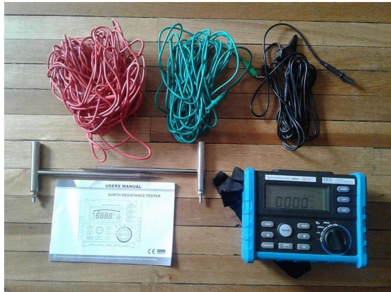
**Figura 4.10** Telurómetro BSIDE AER01.
