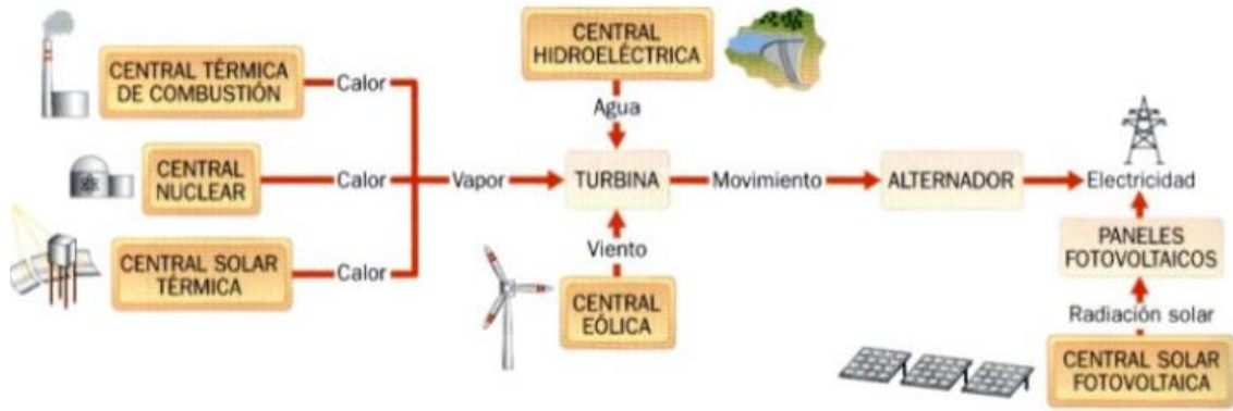
Figura 3.1 Diagrama general de producción eléctrica [20].
