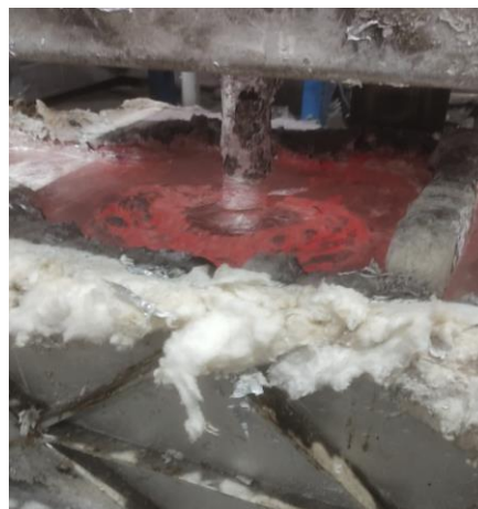
Figura 17: Inyección de Argón en el desgasificador en fundición de Cedal S.A
