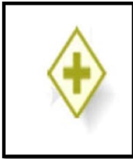
**Figura 2.37:** Gráfico de una Compuerta Paralela [20].
