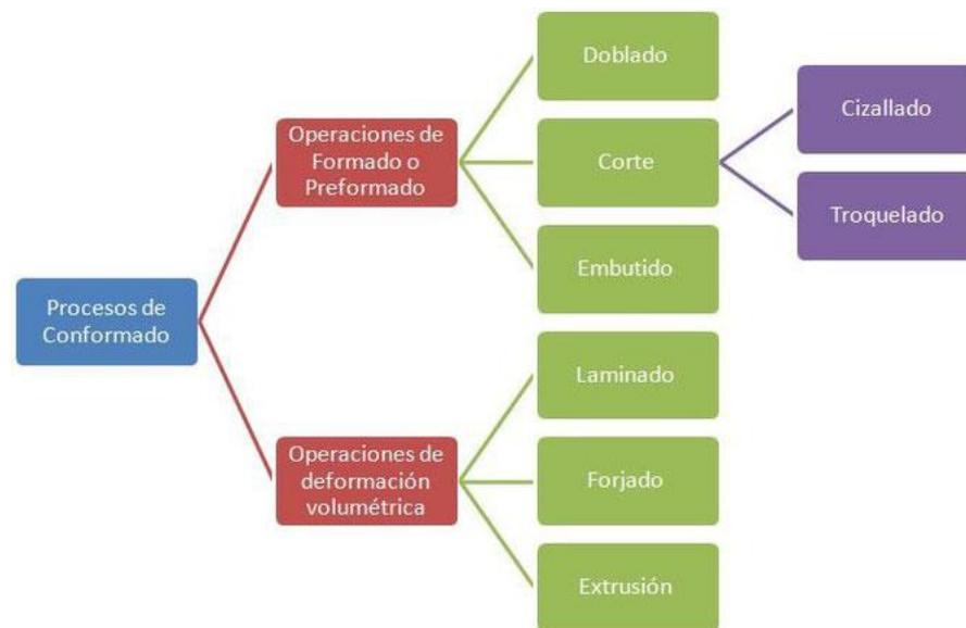
**Figura 2.5:** Procesos de conformado [19].
