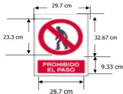
Figura 7 Señalización de Prohibición
