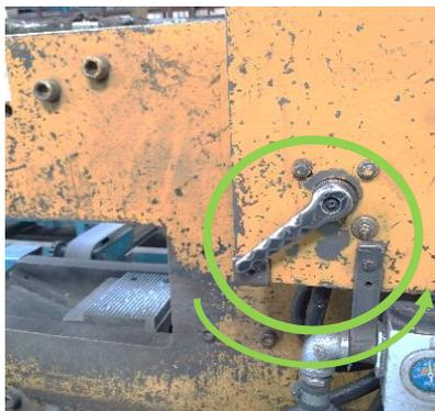
**Figura 11:** Girar la palanca a la derecha.
