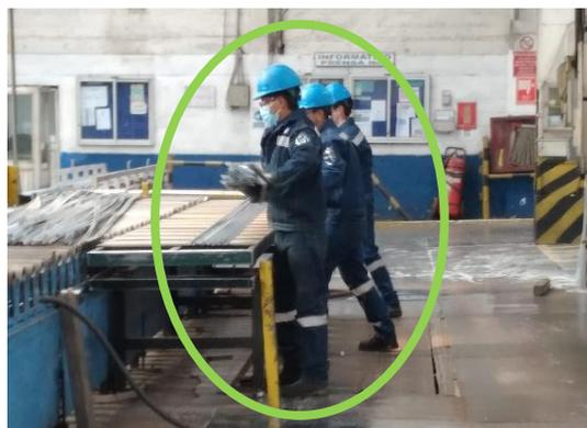
Figura 16: Subir material con defectos a los rodillos.
