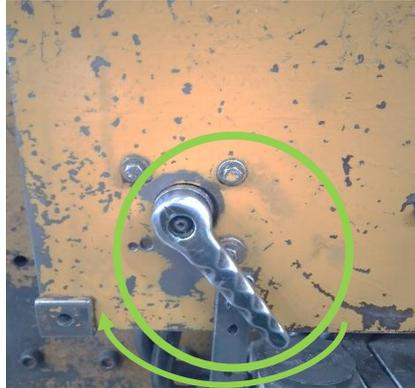
**Figura 13:** Girar la palanca a la izquierda.
