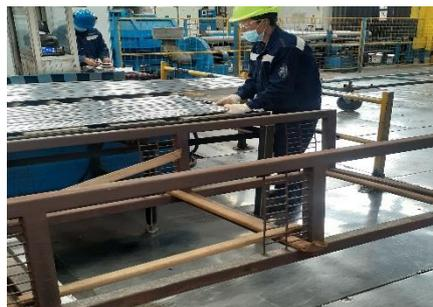
**Figura 7:** Verificar el material para clasificar los perfiles con defectos.
