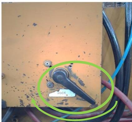
**Figura 7:** Girar la palanca a la izquierda.
