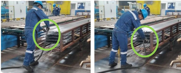
Figura 11: Limpiar los perfiles con aire comprimido.
