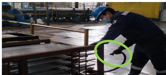
Figura 13: Limpiar los perfiles con aire comprimido.
