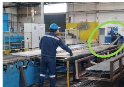
**Figura 8:** Desechando perfiles con defectos.
