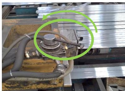
**Figura 11:** Mover la palanca hacia el lado izquierdo.
