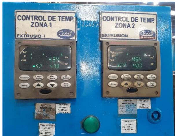
Figura 8: Control de temperatura del horno de lingotes.
