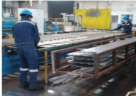
**Figura 5:** Verificar el material para clasificar los perfiles con defectos.
