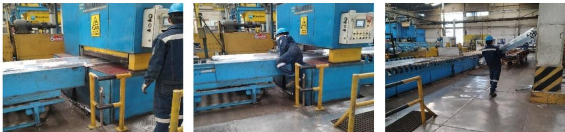
**Figura 22:** Corte y transporte de perfiles dañados al contenedor de chatarra.
