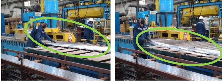
**Figura 4:** Paso del material de los rodillos a la balanza.
