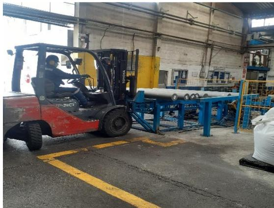
**Figura 4:** Lingotes colocados sobre mesa de alimentación.
