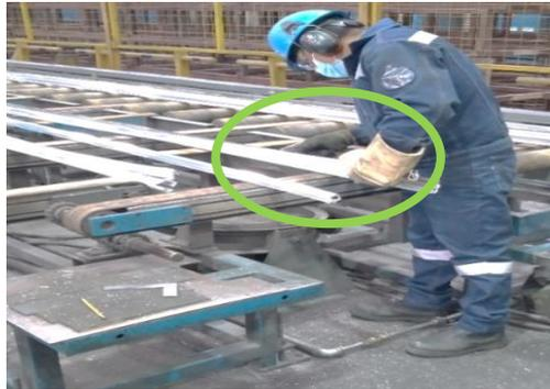
**Figura 12:** Ayudante de prensa verificando las medidas con un calibrador.
