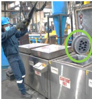
**Figura 3:** Retirando matriz del horno.
