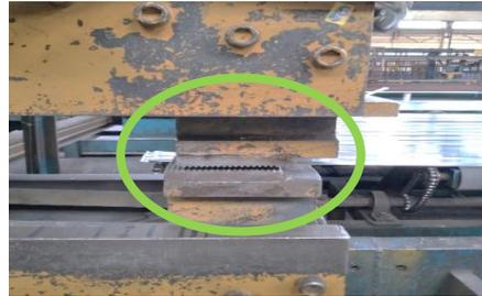
**Figura 7:** Boca de la estiradora móvil cerrada suietando las puntas del material.
