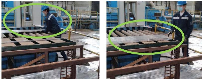
**Figura 6:** Paso del material de los rodillos a la balanza.
