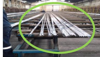
**Figura 3:** Perfiles cerca de la estiradora.
