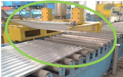
**Figura 17:** Tope de sierra levantado.
