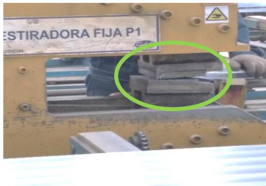
**Figura 12:** Boca de la estiradora fija cerrada sujetando las puntas del material.
