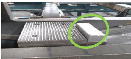
**Figura 5:** Taco de aluminio en la boca de la estiradora.
