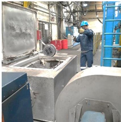
**Figura 15:** Operador sacando matriz del horno.
