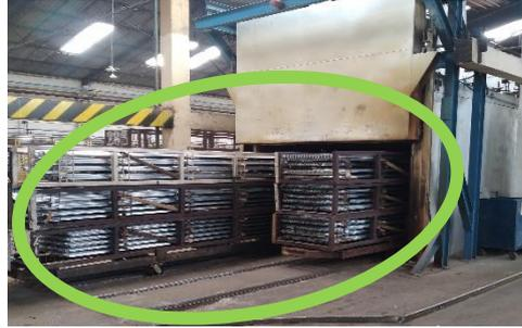
**Figura 10:** Perfiles fuera del horno de envejecimiento.
