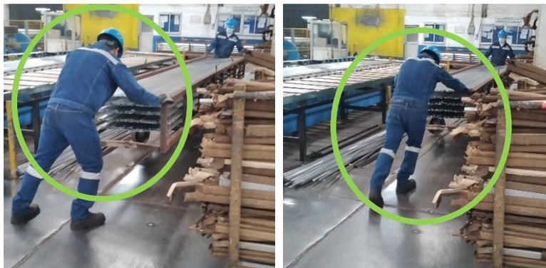
Figura 12: Empujar las canastillas llenas para que el operador de montacargas las apile.
