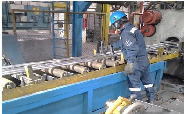
**Figura 9:** Palillos de grafito en los orificios de la mesa de enfriamiento.
