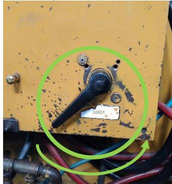
**Figura 3:** Girar la palanca a la derecha.
