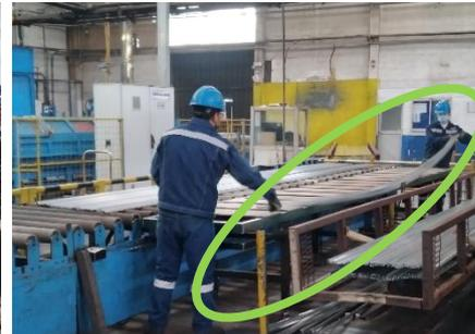
**Figura 6:** Desechando perfiles con defectos.
