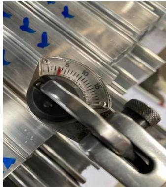
**Figura 11:** Verificar dureza de los perfiles.
