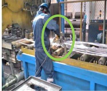
**Figura 7:** Trabajador cortando las puntas de los perfiles.
