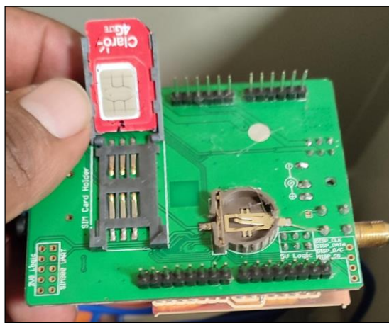
Figura 2.6. Inserción de la tarjeta SIM
