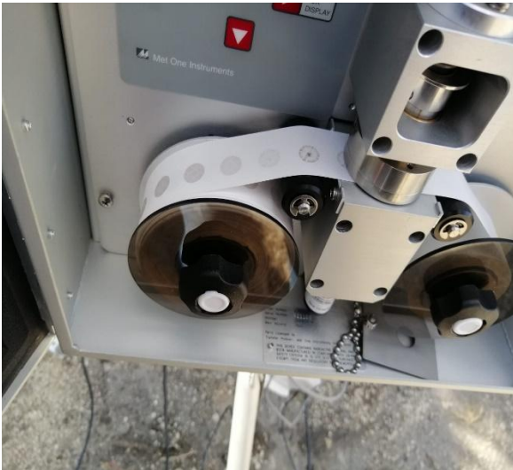
Anexo 10. Recorrido del papel filtro a través del nozzle
