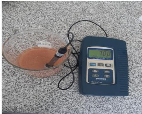
**Imagen 05.** Medición de pH desmineralizado
