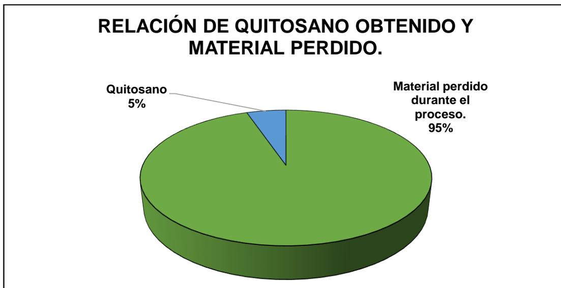
**Figura 13.** Porcentaje de quitosano y material perdido con la masa total utilizada.
