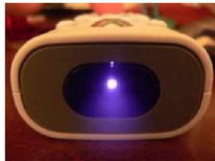
**Figura 2.9. Luz IR vista con el CCD de una cámara digital.**
