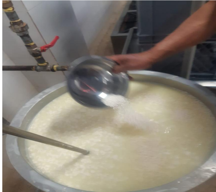
Figura 3. Adición de fermento y la cuajada
