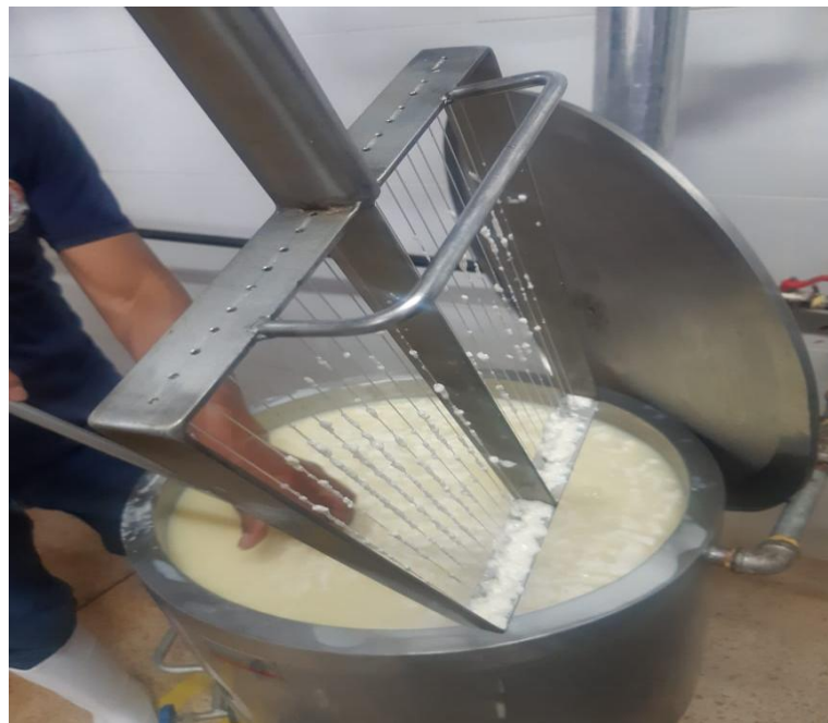
Figura 4. Corte y desuerado
