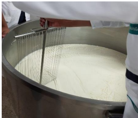
Figura 9 Corte y desuerado
