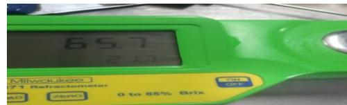
**Ilustración 8: Medición de grados Brix.**
