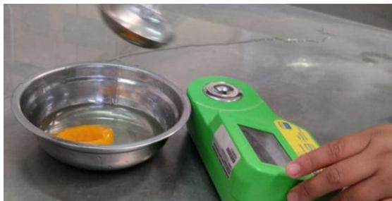
*Ilustración 11: Medición de grados Brix*
