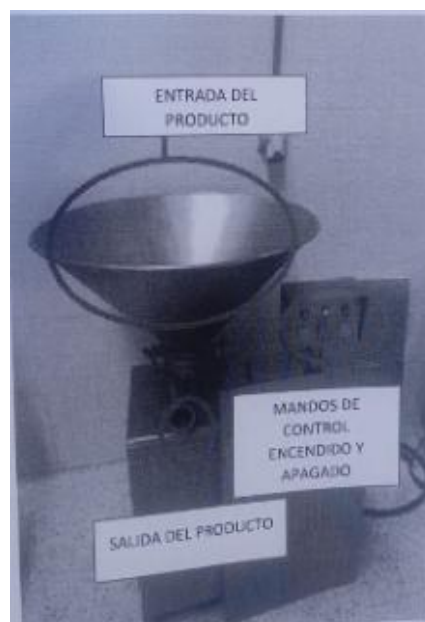
Ilustración 1. Partes principales que cuenta la emulsificadora de carne.
