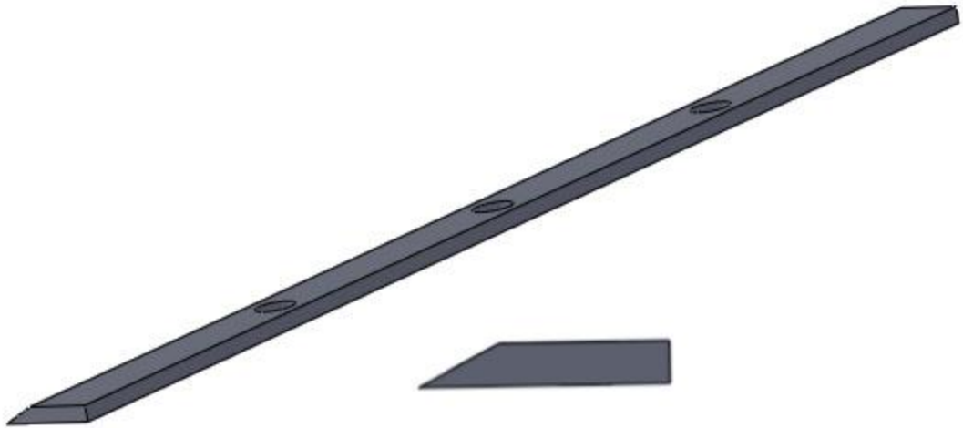
Fig. 3.4 Representación del modelo 3D del elemento de corte de la máquina de corte de fibras de Henequén [26, 27]
