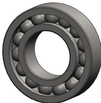
Fig. 3.6 Representación del modelo 3D del rodamiento de la máquina de corte de fibras de Henequén [26, 27]
