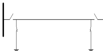
GRÁFICO 21: Instalación a Tierra
