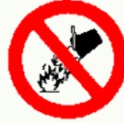
Prohibido apagar con agua
